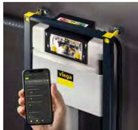
Das „Prevista Dry“-WC-Element mit AquaVip-Spülstation“ hilft, Kalt- und Warmwasser führende Trinkwasserinstallationen vor hygienekritischen Stagnationsrisiken zu schützen. (Foto: Viega)
